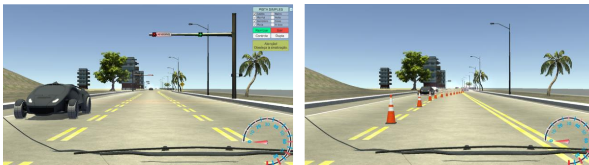
Figura 3: Sinalização de controle da faixa reversível por semáforos (esq.) e por cones (dir.).
