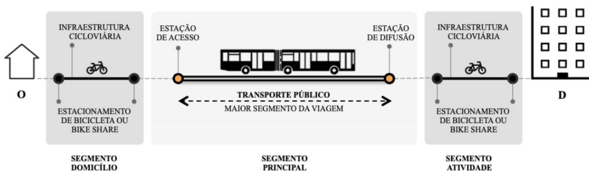
Figura 1: Estrutura característica das viagens integradas bicicleta-TP. Fonte: Costa (2019)
