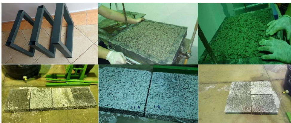
Figura 4: Processo de moldagem das placas de concreto.
