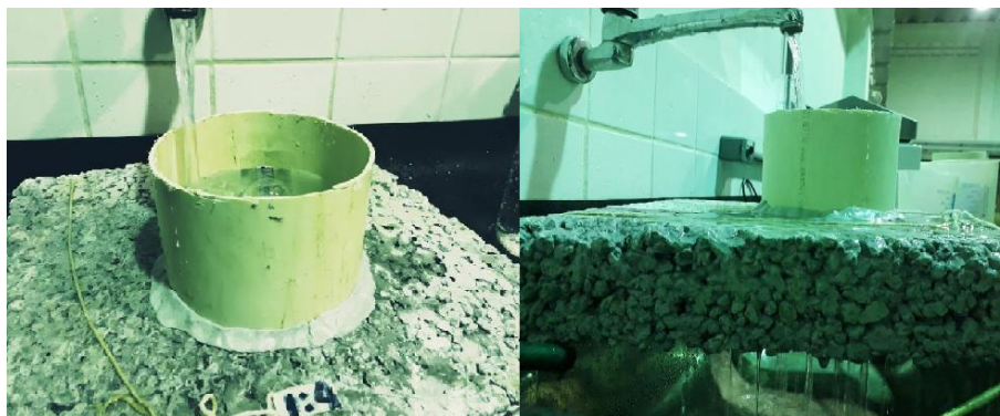
Figura 4: Realização do ensaio de permeabilidade.
