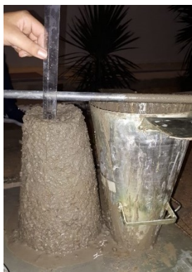
Figura 6: Slump test do T25
