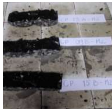
(c) Corpos de prova rompidos
