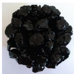
Figura 2: Aspecto visual da adesividade ligante-agregado após condicionamento
