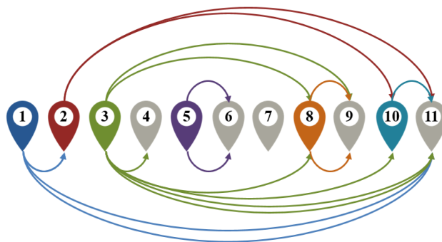
Figura 7: Matriz O/D reconstruída para o segundo trecho. As linhas acima representam a matriz obtida com um sniffer , enquanto que as de baixo a obtida com três sniffers .
