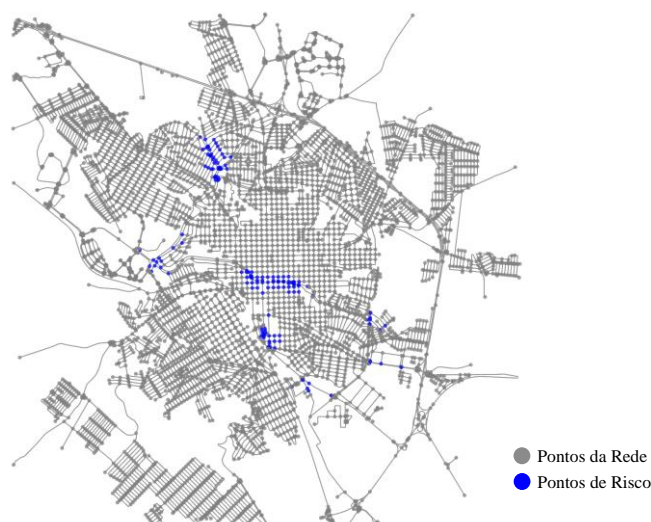
Figura 3: Grafo da cidade de São Carlos-SP com dados de pontos com risco de alagamento.
